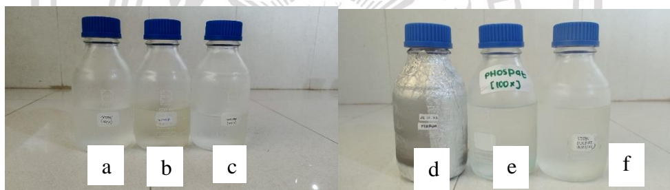
Gambar 3.5 Larutan Stok Media MS (a) Nitrat, (b) Vitamin, (c) Halidah, (d) Ferrum, (e) Phospat, (f) Sulfat Sumber : Dokumen Pribadi (Oktober 2023)
