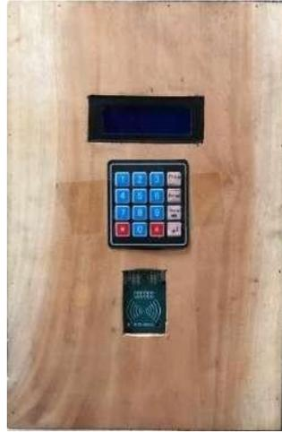
Gambar 6. Hasil Rancangan Sistem Kotak Berukuran 37x24x12
