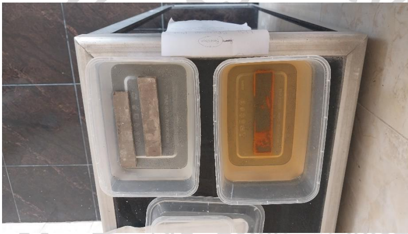
Gambar 3. 10 Kondisi air pada 96 jam pencelupan
