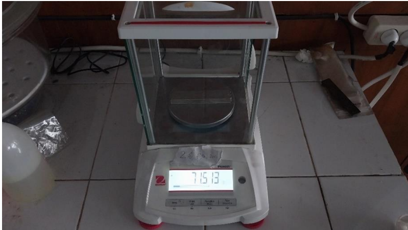
Gambar 3. 18 hasil Penimbangan Spesimen aluminium pada 576 jam
