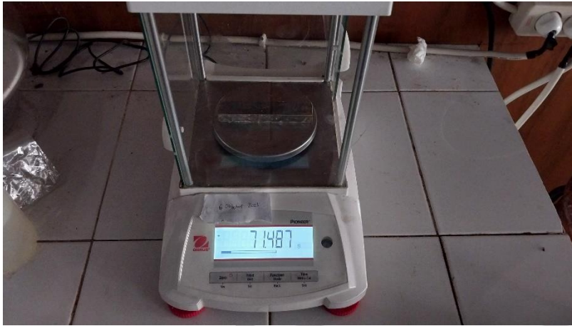
Gambar 3. 9 Penimbangan Spesimen aluminium pada 96 jam
