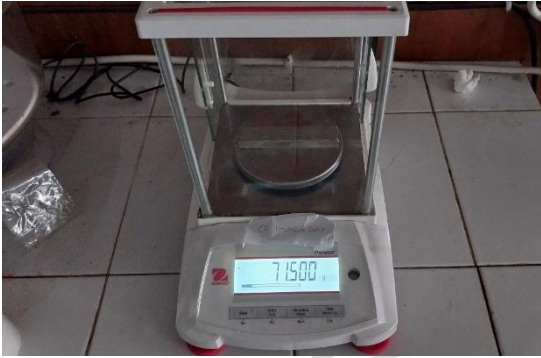
Gambar 3. 20 hasil Penimbangan Spesimen aluminium pada 720 jam
