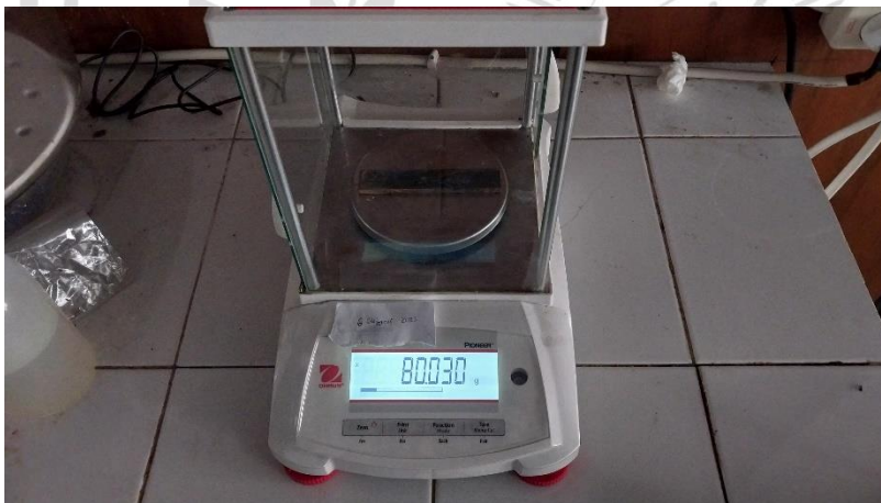
Gambar 3. 8 Hasil Penimbangan Spesimen Baja Pada 96 Jam
