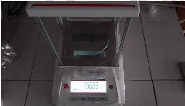
Gambar 3. 21 hasil Penimbangan Spesimen baja pada 720 jam
