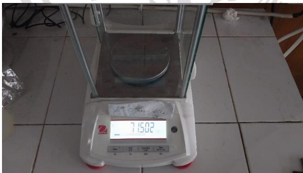
Gambar 3. 15 hasil Penimbangan Spesimen aluminium pada 504 jam
