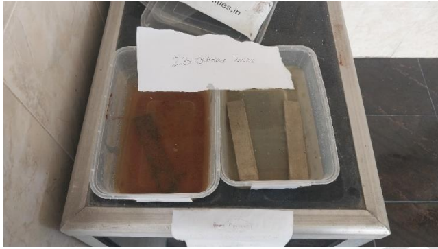
Gambar 3. 16 Kondisi air pada 504 jam pencelupan
