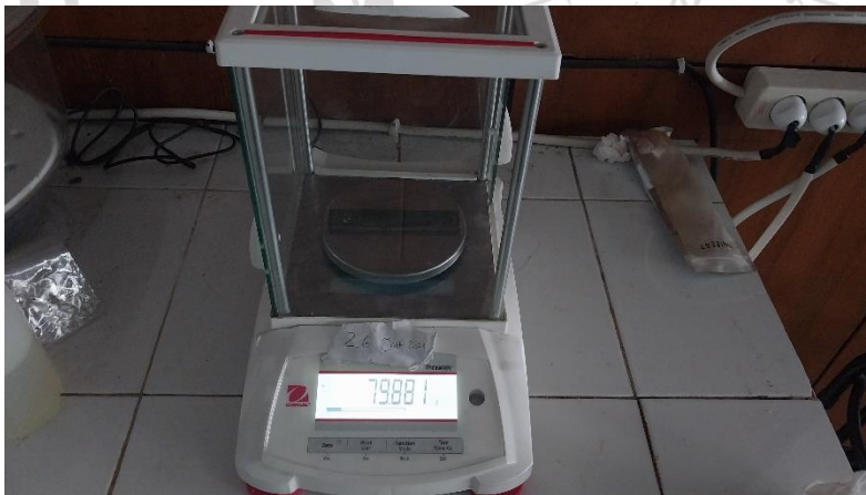
Gambar 3. 17 hasil Penimbangan Spesimen baja pada 576 jam
