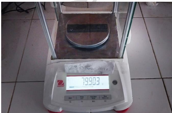
Gambar 3. 14 hasil Penimbangan Spesimen Baja pada 504 jam
