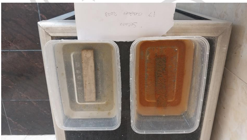
Gambar 3. 13 Kondisi air pada 360 jam pencelupan
