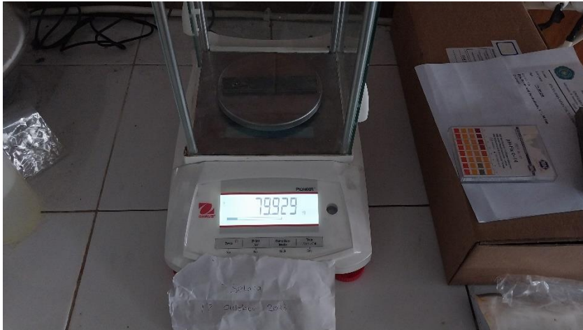
Gambar 3. 11 hasil Penimbangan Spesimen Baja pada 360 jam
