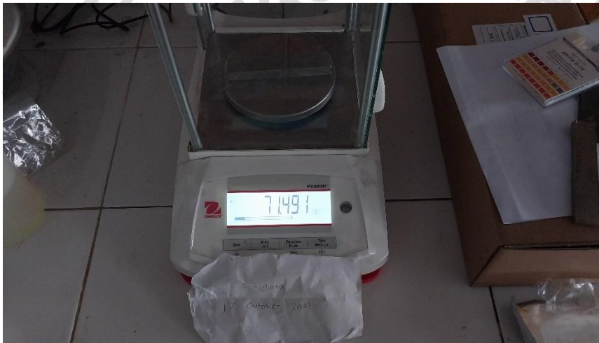
Gambar 3. 12 hasil Penimbangan Spesimen aluminium pada 360 jam
