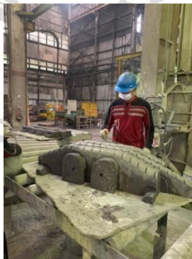
Gambar 2. 9 Coating manual cetakan
