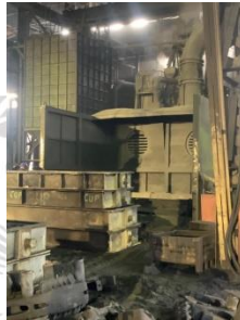
Gambar 2. 13 Stel cup dan drag cetakan
