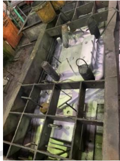
Gambar 2. 5 Pemasangan sleeve dan gating system
