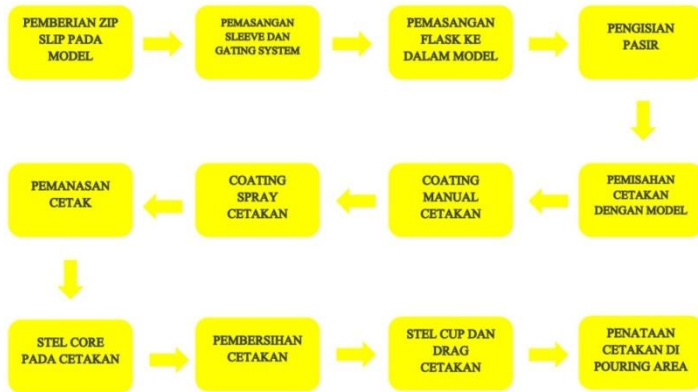
Gambar 2. 3 Proses produksi cetak bogie ( Sumber : Divisi pabrik pengecoran PT. Barata Indonesia )
