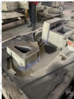
Gambar 2. 6 Pemasangan flask ke dalam model
