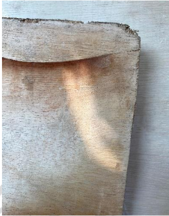
Ujung Kayu Tidak Siku
