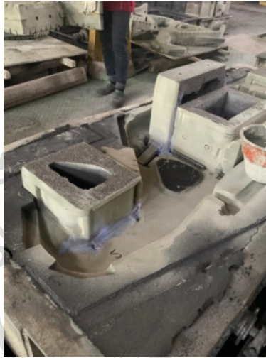
Gambar 2. 7 Pemasangan flask ke dalam model
