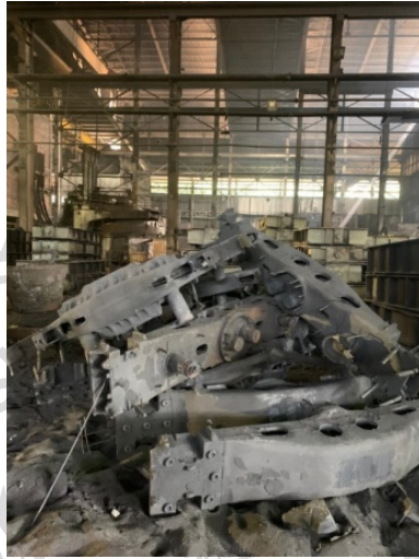
Gambar 2. 15 Penataan cetakan di pouring area
