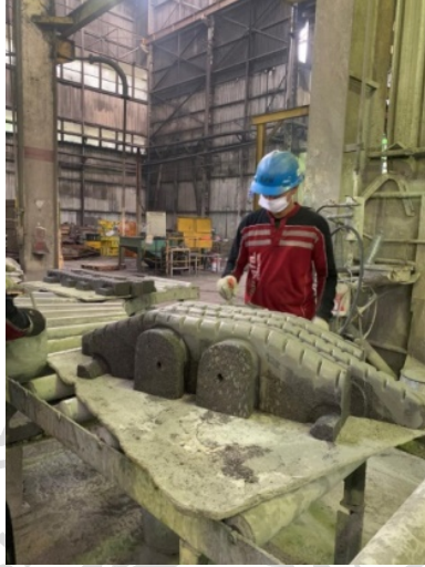
Gambar 2. 10 Coating manual cetakan
