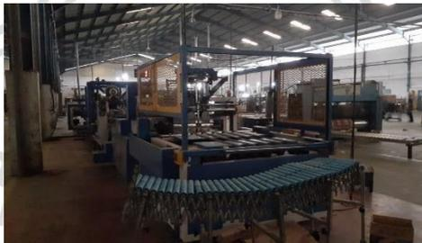
*Gambar 2. 11 Mesin Straping*
