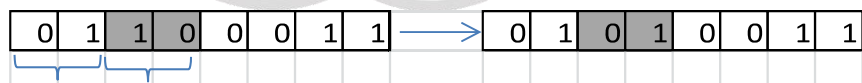
Gamabar 2.5 Contoh mutase pada tingkat gen. semua bit dalam suatu gen berubah
