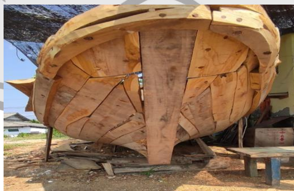
Gambar 2.9 Pembentukan lambung kapal sumber : dokumentasi pribadi
