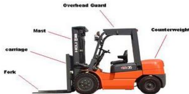
Gambar 2.1 Bagian-bagian mesin forklift (Syahroni, 2017)
