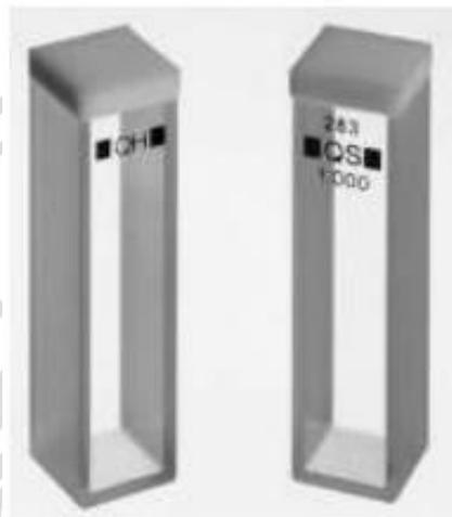
**Gambar 2. 8** Kuvet yang digunakan dalam spektrofotometer UV-Vis
