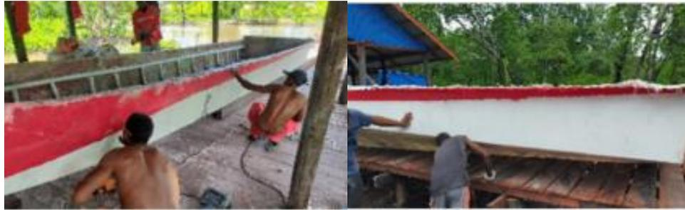
**Gambar 2.5** Pengecekan bagian yang perlu di-finishing dan Proses finishing Lambung Kapal fiberglass [7]
