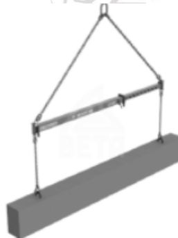
Gambar 2.8 Pengangkatan Balok Pracetak (Sumber : Larasati, 2020)
