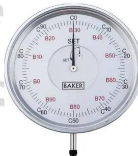
**Gambar 2.10** Dial indikator pada mesin rockwell
