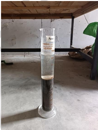
Pengujian Kandungan Organik Pada Agregat
