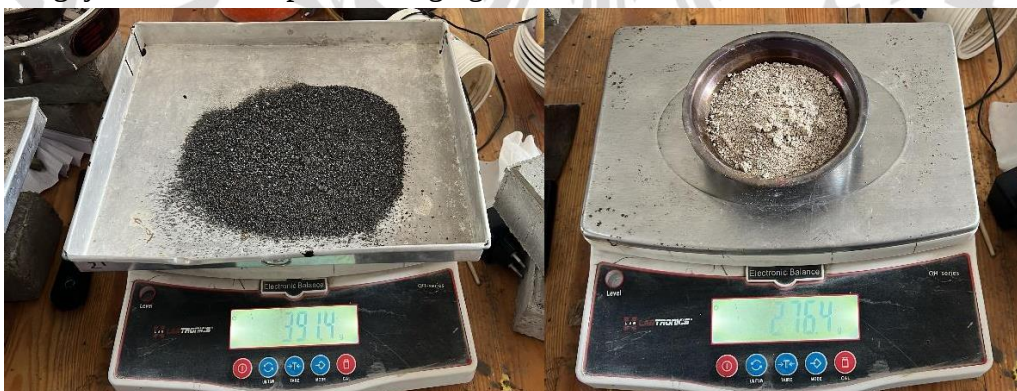
Pengujian Kadar Lumpur Pada Agregat
