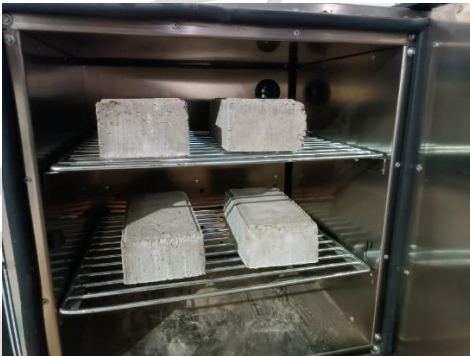
Pengujian Penyerapan Air paving block
