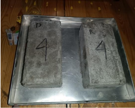
Benda Uji Untuk Pengujian Penyerapan Air
