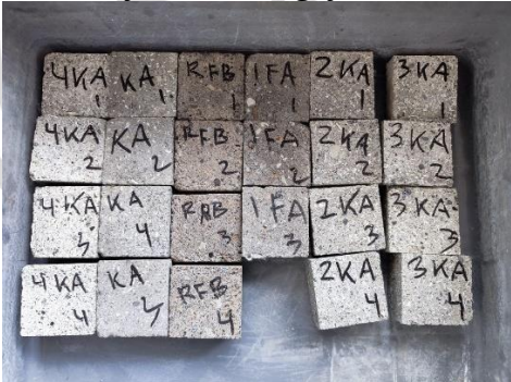
Benda Uji untuk Pengujian Keausan
