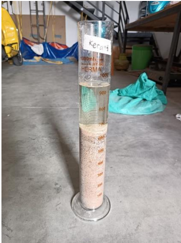
Pengujian Kandungan Organik Pada Agregat
