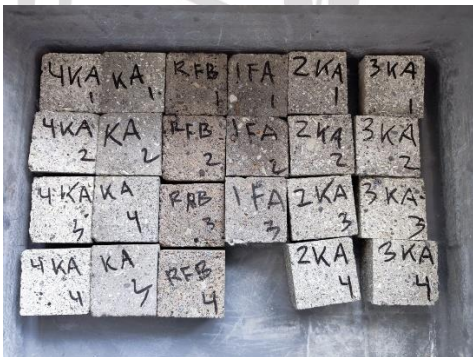
Benda Uji untuk Pengujian Keausan
