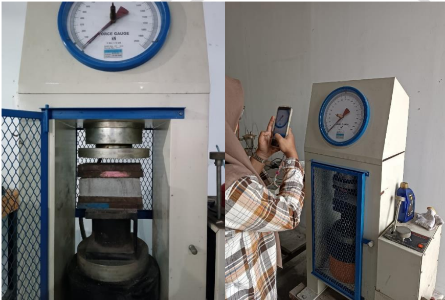
Pengujian Kuat Tekan Paving block
