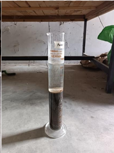
Pengujian Kandungan Organik Pada Agregat
