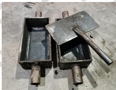
Gambar 3.8 Cetakan Benda Uji
