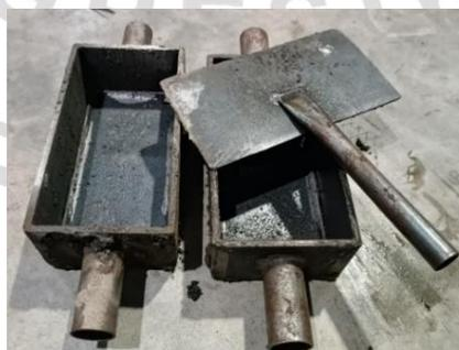
Gambar 3.18 Cetakan *Paving block*
