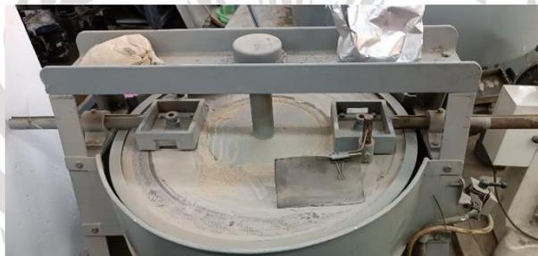
Gambar 3.10 Mesin Uji Aus
