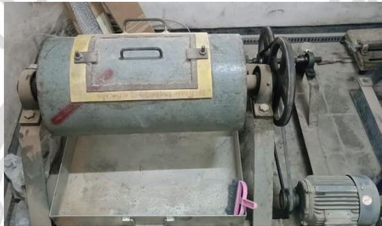
Gambar 3.16 Alat Penggiling Kerang (*Ball Mill*)
