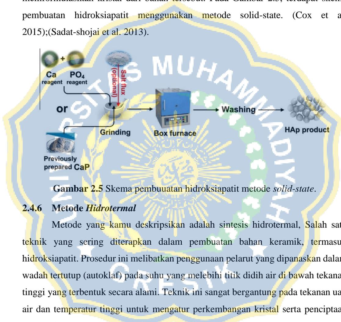
**Gambar 2.5** Skema pembuuatan hidroksiapatit metode *solid-state*.
