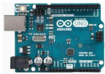
**Gambar 3.** Mikrokontroler Arduino Uno
