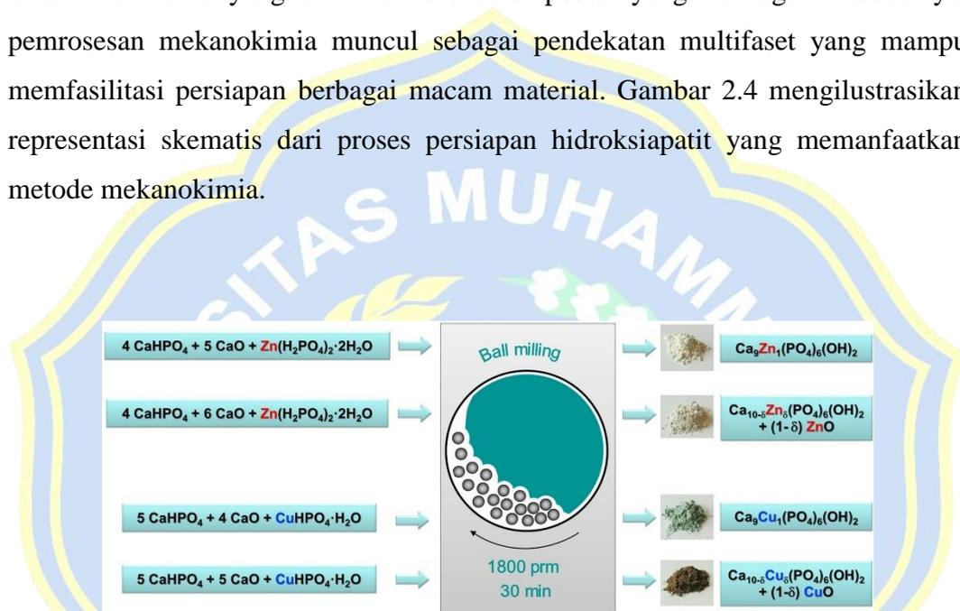
**Gambar 2. 4** Skema pembuatan hidroksiapatit metode mechanochemical.
