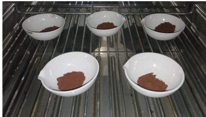
Gambar 19. Sampel Dioven Selama 3 Jam dengan Suhu 105°C
