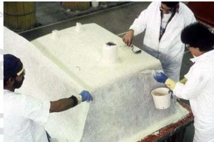
Gambar 2.26 Membuat kapal fiber menggunakan metode Hand Lay Up.
