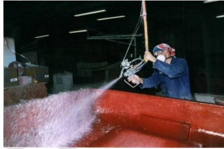
Gambar 2.27 Membuat kapal fiber menggunakan metode Spray Up.
