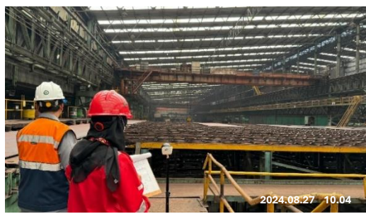
Pengukuran iklim kerja panas menggunakan heat stress
