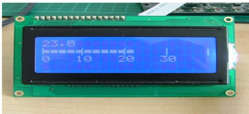
Gambar 2.10. Modul dari LCD
