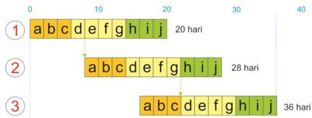
Gambar 2.14 Kebutuhan sumber daya pada tiga proyek tidak menggunakan *multitasking*
