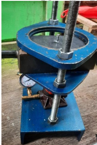
Gambar 4 menjelaskan alat pengempresan paving block dengan hidrolik dibawahnya.
