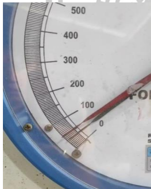
Gambar 3 menunjukkan pengujian kuat tekan dengan kode benda uji PK3 (limbah plastik HDPE 50% : cangkang kerang simping 50%)
