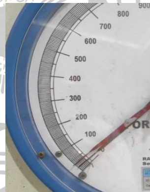
Gambar 4 menunjukkan pengujian kuat tekan dengan kode benda uji PK4 (limbah plastik HDPE 25% : cangkang kerang simping 75%)
