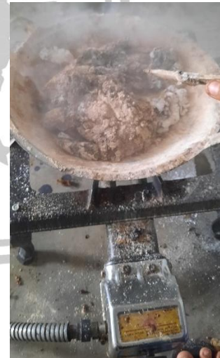
Gambar 6 proses pencampuran cangkang kerang simping.
