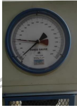
Gambar 2 menunjukkan pengujian kuat tekan dengan kode benda uji PK2 (limbah plastik HDPE 75% : cangkang kerang simping 25%)
