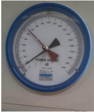
Gambar 1 menunjukkan pengujian kuat tekan dengan kode benda uji PK1 (limbah plastik HDPE 100% : cangkang kerang simping 0%)
