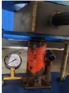
Gambar 3.6 Dongkrak (hidrolik) (Sumber : Dokumentasi Penulis, 2025)
