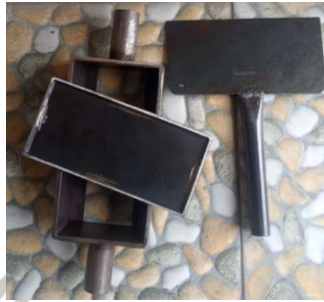
Gambar 3.4 Cetakan paving block (Sumber : Dokumentasi Penulis, 2025)
