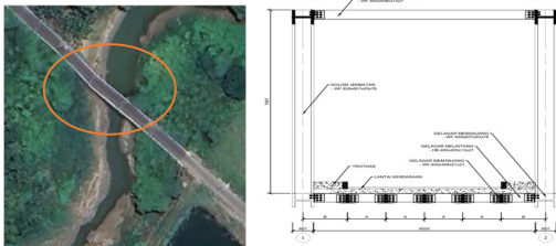
Gambar 3. Layout dan Potongan Melintang Jembatan
