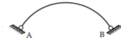
Gambar 2.10 Struktur 2 Sendi (Sumber: W.-F. Chen & Duan, 2014)
