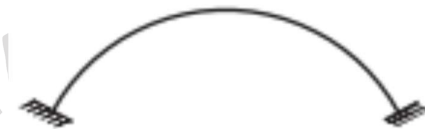
Gambar 2.11 Struktur Jepit (Sumber: W.-F. Chen & Duan, 2014)
