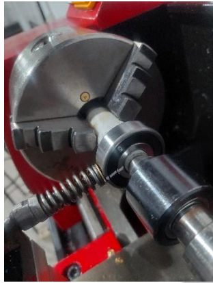
Uji putar bearing tanpa perlakuan
