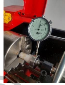
Pemresisian bearing sebelum dilakukan uji putar
