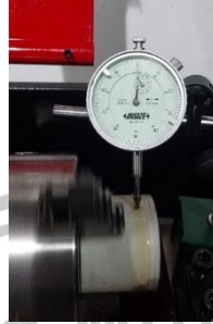
Pemasangan, pemresisian teflon road sebelum dilakukan uji kerataan pada outer bearing
