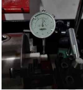
Pemasangan, pemresisian teflon road pada mesin bubut sebelum dilakukan uji putar dan pengujian kerataan bagian inner bearing
