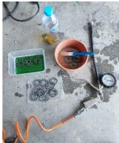
pembersihan greasse dari pabrik
