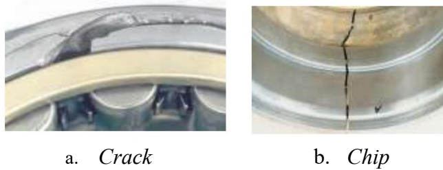
Gambar 2. 10 a. Crack dan b. Chip ( Koyo, 2013 )
