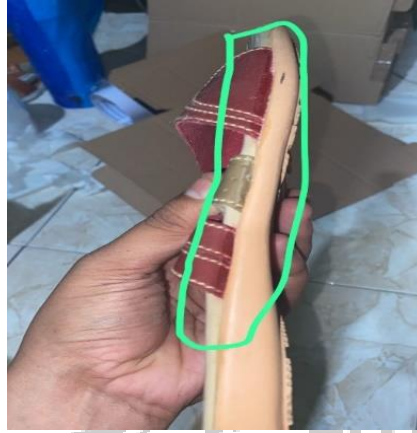
Gambar 1.8 Sisa lem yang meluber di sisi sandal
