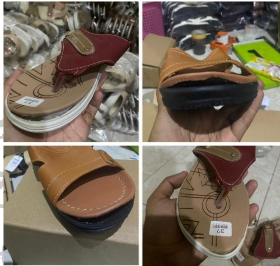
Gambar 1.7 Kurang melekat atau antara katoan dan sol menganga
