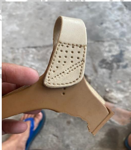
Gambar 1.3 pemotongan kap tidak presisi
