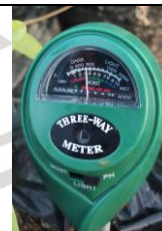
Gambar 8 Pengukuran Ph & Kelembaban Tanah Sumber : Dokumentasi Pribadi 2021
