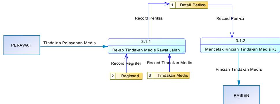
**Gambar 3.13 DFD Level 2 Proses Pelayanan Rawat Jalan**
