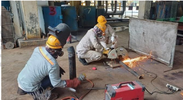
Lampiran 1. 2 Pemotongan besi menggunakan speed cutting
