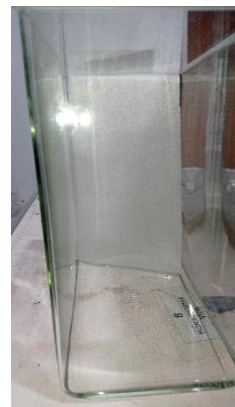
Proses eluen dijenuhkan dengan kertas saring
