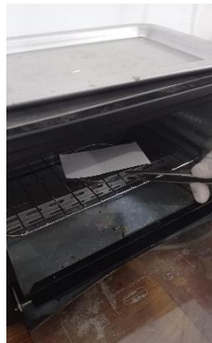
Plat KLT di oven dalam suhu 110°C selama 60 menit
