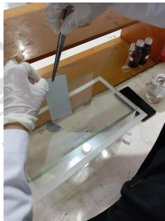
Plat KLT dimasukkan dalam chamber yang sudah berisi eluen
