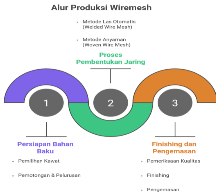
Gambar 1.5 Alur produksi Wiremesh
