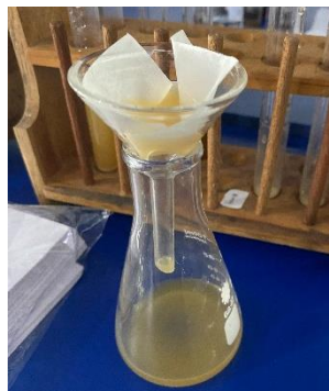
Ditunggu selama 30 menit kemudian dilakukan penyaringan pada masing-masing sampel.
