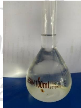
Dimasukkan larutan \text{NaNO}_2 ke dalam labu ukur 100 mL dan ditambahkan aquadest hingga tanda batas, kemudian dikocok hingga homogen
