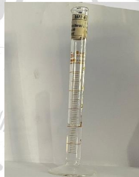
Diukur BaCl 2 10% sebanyak 2 mL dan dimasukkan ke dalam tabung reaksi
