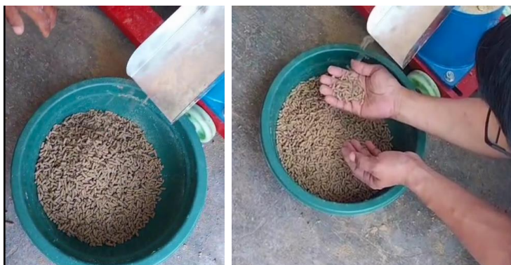
Gambar 16. Proses Pencetakan Pellet Pakan Apung
