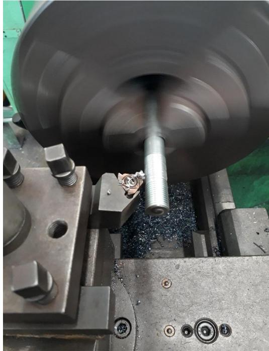
Gambar 1.3 Proses Penguliran
