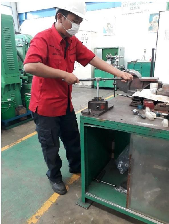
Gambar 1.4 Pengerjaan penguliran Manual
