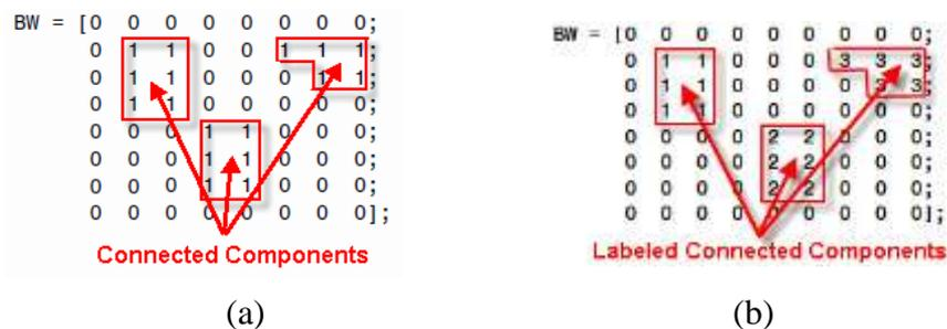
**Gambar 2.8** Ilustrasi Pelabelan komponen; (a) komponen terhubung, dan (b) pelabelan komponen terhubung
