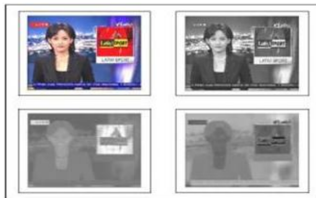
Gambar 2.9 searah jarum jam dari kiri atas citra RGB, komponen Luminance (L), Chrominance Blue (Cb), Chrominance Red (Cr)
