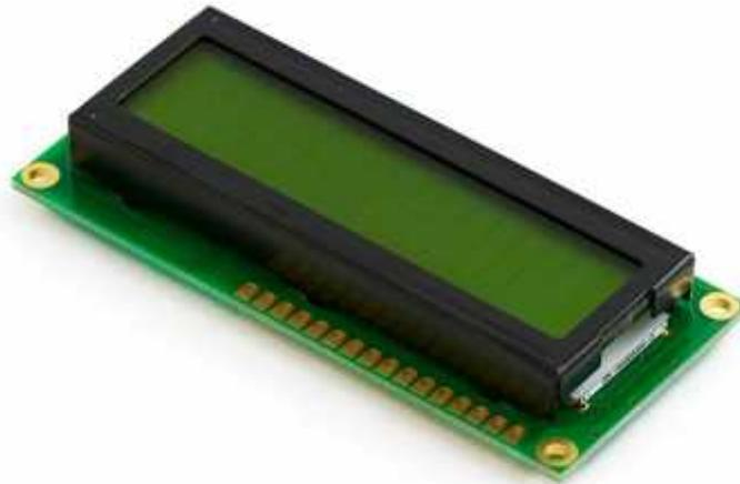
Gambar 2.6 LCD 16x2
