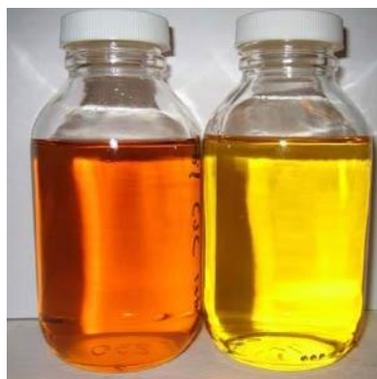
**Gambar 2.6** Minyak Isolasi Trafo
