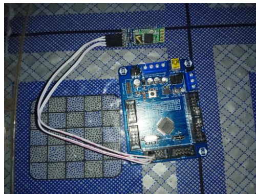
Gambar 3.5 Koneksi Nuvoton NUC 120 dengan Modul Bluetooth HC-05
