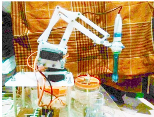
Gambar 3. 14 Perancangan Mekanik Robot ARM
