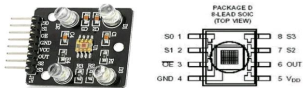
Gambar 2.6 (a) bentuk fisik sensor TCS230 (b) skema pin sensor TCS230
