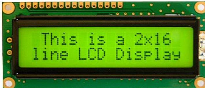
**Gambar 2.18.** Bentuk Fisik LCD 16 x 2
