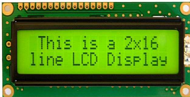
Gambar 2.14 Bentuk Fisik LCD 16 x 2
