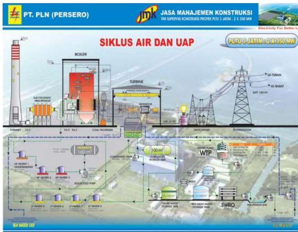
Gambar 2.1 Komponen-komponen Pembangkit Listrik Tenaga Uap
